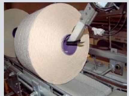
Kreuzspulenlifter und Textra-Spulentransportsystem an OE-Spinnmaschinen
