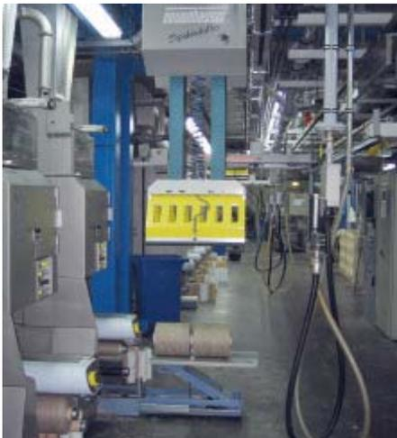
Die Doff- und Handlingsysteme passen sich optimal in die Produktionsumgebung ein. Es gibt unterschiedliche Doff-Systeme für die einzelnen Wicklertypen. Die Geräte sind so konzipiert, dass sie auch die Betriebssicherheit mit Rücksicht auf das Bedienpersonal gewährleisten.
