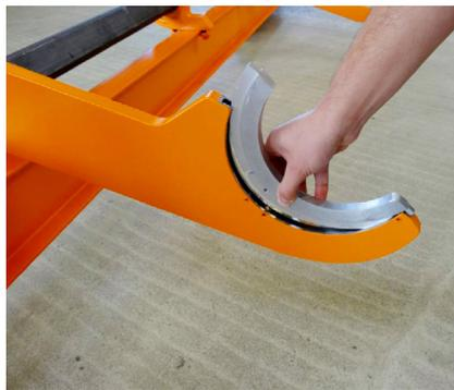
Ausführung mit Adapter für unterschiedliche Rohr-Durchmesser
