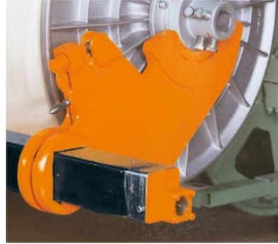
Ausführung mit höhenverstellbaren Rohrgreifern, z.B. für Steckachsen
