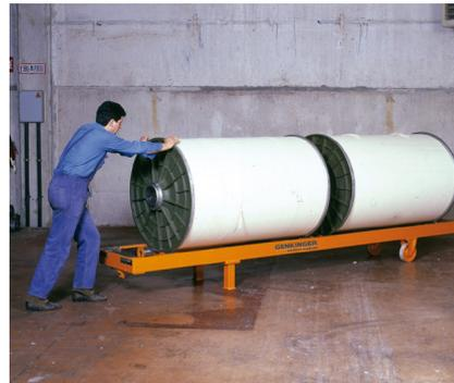
Ausrichten der Teilkettbäume durch Drehen und Verschieben
