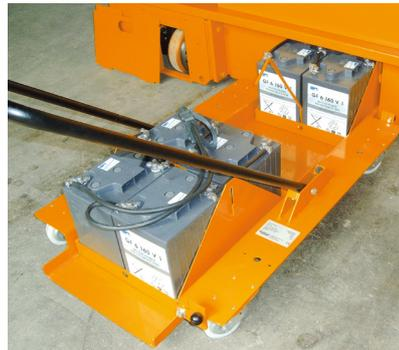
Gerät ist vorbereitet für ein optionales Wechselbatteriesystem
