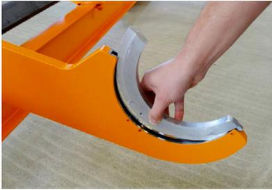
Adapter für unterschiedliche Rohrdurchmesser
