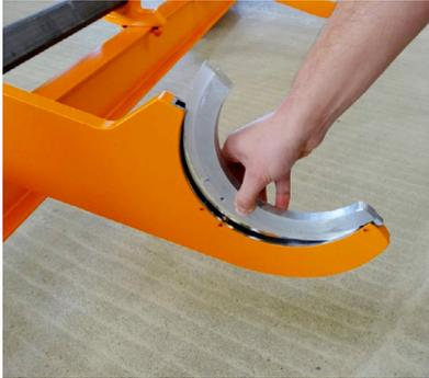
Ausführung mit Adapter für unterschiedliche Rohr-Durchmesser
