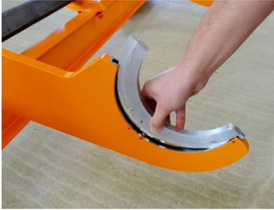
Ausführung mit Adapter für unterschiedliche Rohr-Durchmesser
