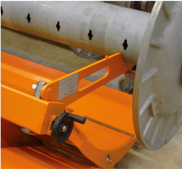
Ausschwenkbare Rohrgreifer für leere Kettbäume
